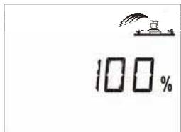
Le programmateur possède une fonction (appelée Water Budget ou ajustement automatique) qui permet de moduler l'apport d'eau sur les 3 programmes de 0 à 200%, et ce sans avoir à modifier les temps d'arrosage de chaque station.
