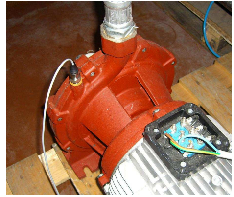
Figure 3: Montage du transducteur sur le trou de remplissage du refoulement
