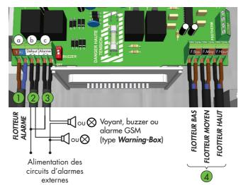
1 Le FLOTTEUR ALARME doit être monté en inverse (normalement fermé).
