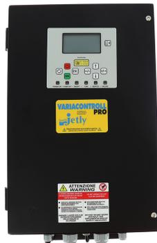
Les **VARIACONTROLL** sont des variateurs de vitesse prévus pour une installation murale. Ils sont conçus pour le pilotage d'une pompe de surface ou d'une pompe immergée équipée d'un moteur monophasé ou triphasé, avec une puissance jusqu'à 15 kW. Chaque variateur est livré avec son capteur de pression. Leur programmation est simple et intuitive. Les **VARIACONTROLL** peuvent-être associés entre eux en filaire pour la réalisation de groupes multi-pompes (jusqu'à 4 pompes).
