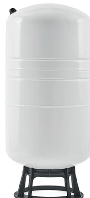
Les réservoirs à diaphragme **AQUAVAREM** sont utilisés dans les applications de surpression nécessitant une réserve de stockage pour limiter les démarrages horaires de la pompe (surpresseurs à pressostats, application d'arrosage, process industriels etc...) La conception à diaphragme offre une solution avantageuse par rapport aux réservoirs à vessie puisque celle-ci évite à l'utilisateur d'avoir à régulièrement contrôler et/ou regonfler son réservoir en air.
