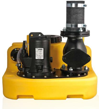
Les stations COMPLI sont des groupes de relevage conçus pour le relevage des eaux usées et chargées d'une habitation complète, de 2 appartements ou bien encore des petits restaurants urbains (séparateur à graisses à prévoir). Ces stations sont 100% étanches et permettent une installation dans des pièces humides et/ou à risque d'inondations. Le coffret de commande quant à lui doit être installé dans une pièce bien ventilée et non inondable.
