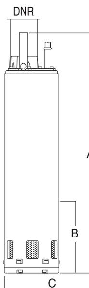
\* Niveau minimum d'aspiration (le moteur étant refroidi par l'eau pompée, la pompe peut fonctionner en partie dénoyée).
