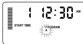
Exemple d'écran clignotant en maintenant enfoncé le bouton PRO-C
