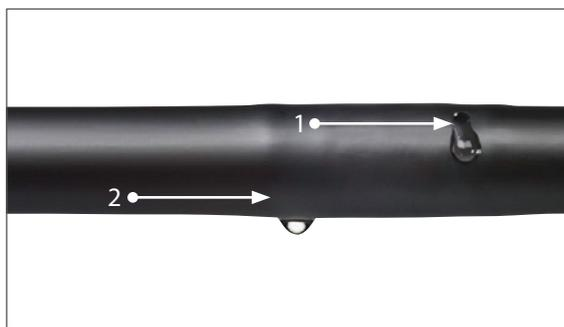
À la différence des autres goutteurs qui ne possèdent qu'une seule sortie, si une des sorties de l'Hydro PC se colmate, la deuxième sortie localisée sur l'autre face reste active pour assurer l'arrosage de votre culture. Un autre avantage de la double sortie, c'est qu'il n'est pas nécessaire de faire
