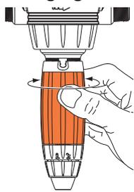
Le réglage du dosage s'effectue en faisant correspondre l'œillet de la bague de réglage à la graduation souhaitée sur la réglette. La quantité de produit injectée est proportionnelle à la quantité d'eau qui entre dans le Dosatron :
