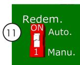
Pour que la pompe redémarre automatiquement après la détection d'un défaut (marche à sec, manque d'eau, surcharge), positionner l'interrupteur de redémarrage ⑪ sur « Auto ».
