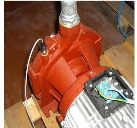
Fig 5: Exemple de raccordement par le trou d'amorçage de la pompe avec transducteur monté
