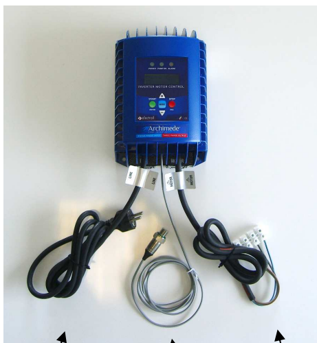
Fig. 4: Raccords d'entrée/sortie et de capteur de pression
